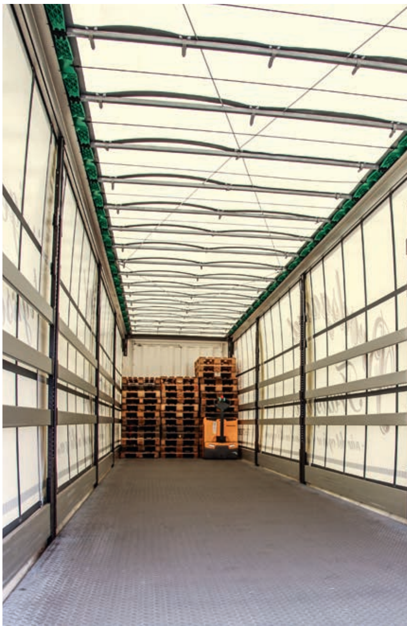
Et kig ind i lasterummet med den specielle bund, som består af en 30 mm vandfast limet finerplade med forseglede snitteflader, som har en styrke for bundbelastning på op til 5.460 kg akseltryk fra gaffeltrucks.
