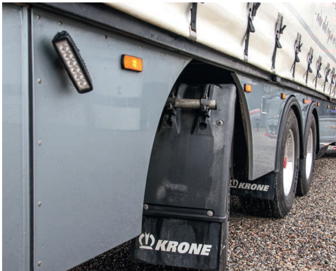
Den bageste aksel er med tvangsstyring, hvor akslen er ophængt på sit eget lille chassis, som er forbundet til trailerchassiset med en drejekrans.
