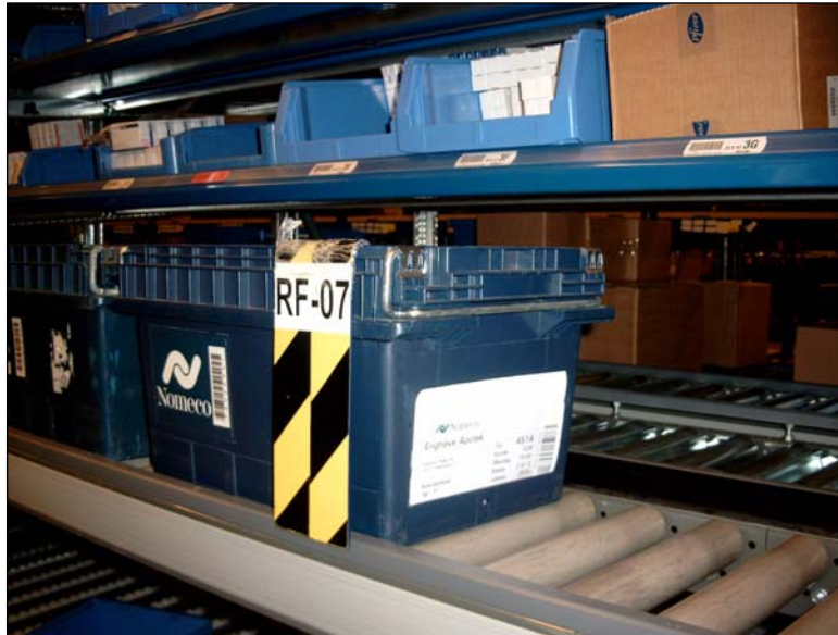
Billedet viser stregkodelabelen på kassen til automatisk registrering ved 'pick-to-light'.
